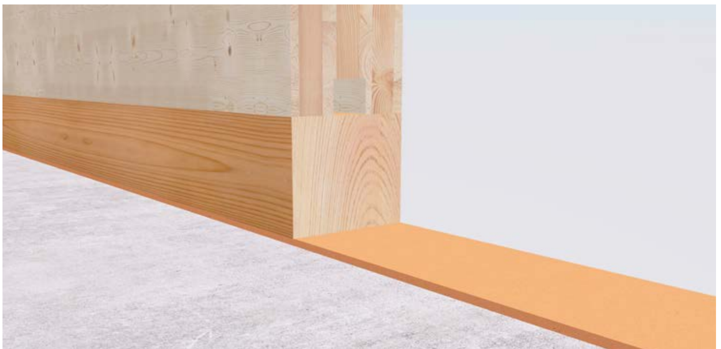
SonoTec zur Trennung und Schallisolierung von Fundament und Schwellenholz.
