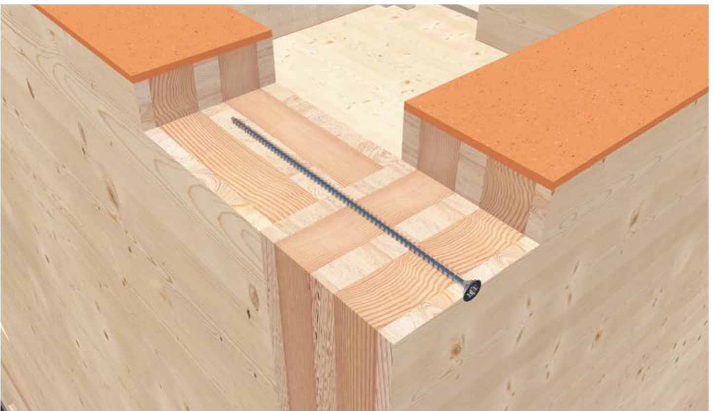
KonstruX zur Verbindung von zwei Wänden.
