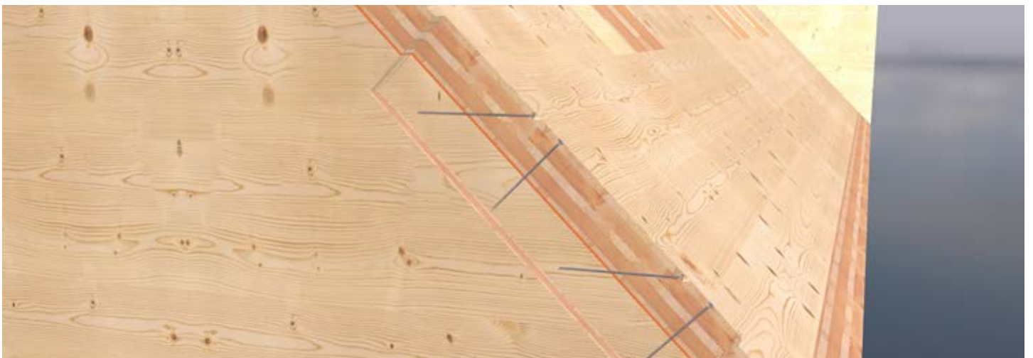
Verbindung von Dach- und Wandelement.
