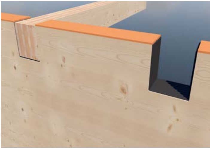
Anwendung Silent EPDM-Entkopplungsprofil unter Balken zur Schalldämmung zwischen Holzbauteilen.
