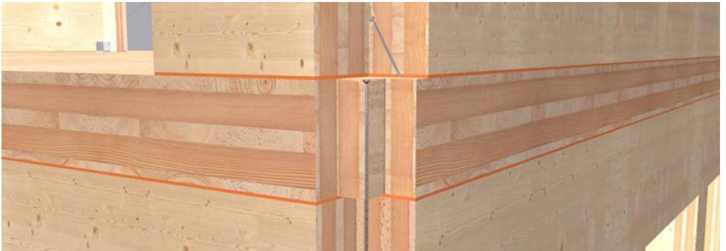
Verbindung von Wand und Holzboden im OG.
