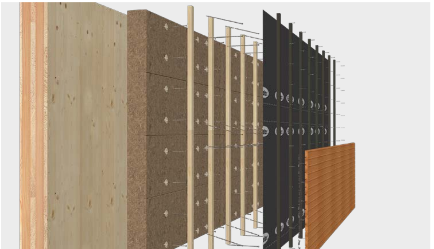
Fassadenaufbau mit Topduo.
