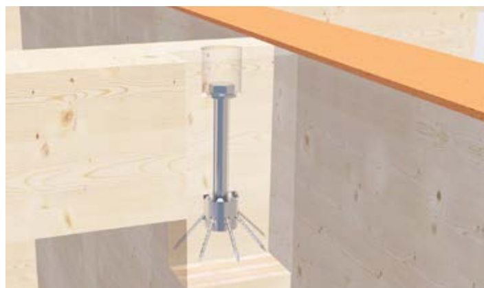
Anwendung IdeeFix zur Verbindung von Stütze und Balkenträger
